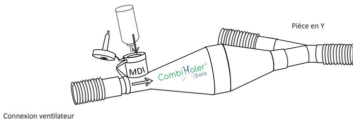
a. Insérer le dispositif CombiHaler® solo dans le circuit de ventilation mécanique entre la branche inspiratoire et la pièce en Y en respectant le sens de la flèche comme indiqué sur le dispositif CombiHaler® solo. Aucun filtre ne doit être interposé entre CombiHaler® solo et le patient.
